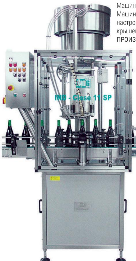
Машина, оснащенная врачающейся закатывающей головкой с четырьмя роликами и бункером для подачи крышек. Машина предназначена для укупорки как укороченными, так и удлиненными крышками после соответствующей настройки головки. Машина сконструирована таким образом, что после замены ориентирующего устройства для крышек и укупорочной головы, возможна укупорка пластиковыми винтовыми или набивными крышками. ПРОИЗВОДИТЕЛЬНОСТЬ плавно регулируется в диапазоне от 1000 до 3000 бутылок в час.
