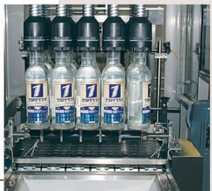
Машины этой серии автоматически группируют и укладывают бутылки в коробки. ПРОИЗВОДИТЕЛЬНОСТЬ от 6 до 24 коробок в час.
