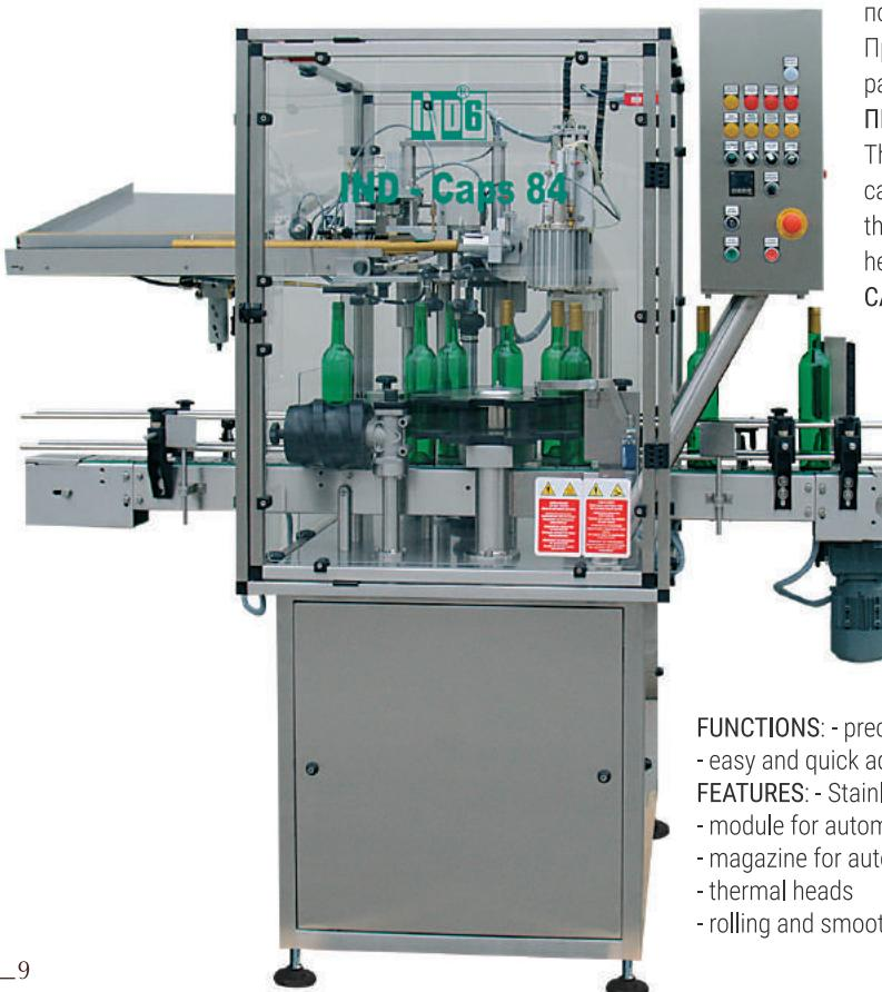
Машины этой серии предназначены для аппликаторирования декоративной термоусадочной или полиламинатной капсулой горлышка бутылок с различными видами горловины. Термоусадка капсулы производится при помощи термоголовок с центрирующими прижимными приспособлениями. При необходимости машина может быть укомплектована головкой для развалицовки полиламинатных капсул.
